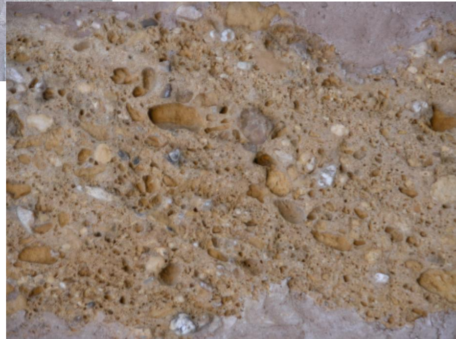
Grès à gros grains (sable, gravier, silice, calcite, mica, feldspath...)
